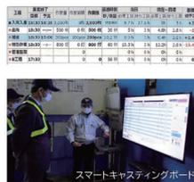
スマートキャスティングボード上で工程毎の過不足工数を一目で確認することができ、マウス一つで人の応受援計画の作成が可能になります。工程間の人の移動も簡単にできます。
